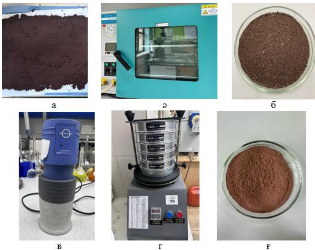
6 сурет - Өндірілген цеолитті тазарту мақсатында шаю процесі а) табиғи цеолитті сумен шайылды; ә) кептіру пешіне 70 °С температурада 24 сағат бойы кептірілді; б) кептіру пешінен шыққан дайын табиғи цеолит; в) цеолитті ұнтақтайтын зертханалық ұнтақтағыш (блендер); г) вибрациялық елеуіш (вибросито); ғ) дайын болған 0,105мм цеолит;
